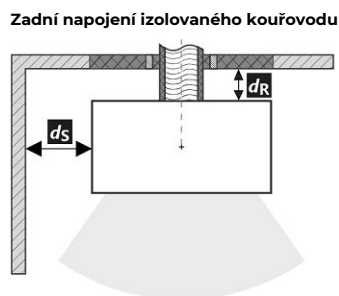
Prostup kouřovodu stěnou z hořlavé hmoty ČSN 06 1008
